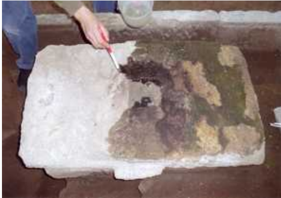
1. 含浸強化剤(1)を全体に浸透させ強化
